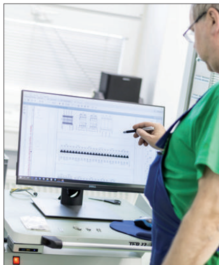
Obr. 3. Pojízdný terminál TED 22 umožňuje výrobu bez papírové dokumentace
