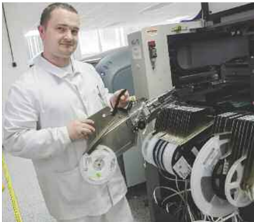
Osazovací linky SMT na výrobu elektronických desek ve vysoké průmyslové kvalitě
